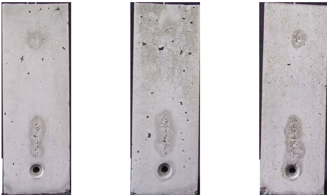
Bilder 4.8: Probekörper von drei unterschiedlichen Feinbetonrezepturen, jeweils aus der gleichen Schalung mit Ankerstelle und definierten Fehlstellen (Schlitz und Loch)
